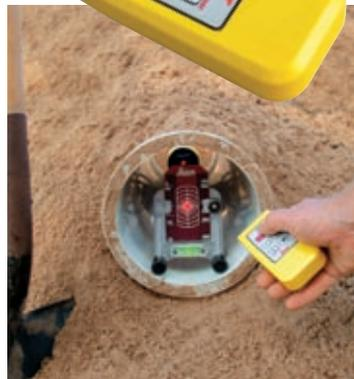
**Control remoto multi-función** trabaja hasta 150 m (500 ft) para control de línea y otras funciones.
