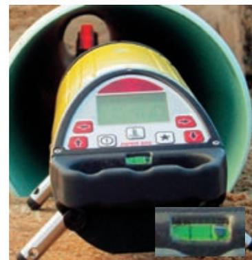
**Compensación automática de la inclinación** en caso de balanceo hasta  $\pm 3^\circ$ ; el Piper compensará y corregirá los errores de inclinación.
