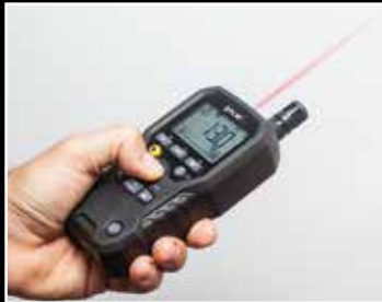
El termómetro IR láser captura la temperatura de la superficie de forma rápida
