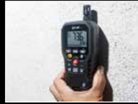
Capture lecturas de humedad de hasta 0,75" por debajo de las superficies.
