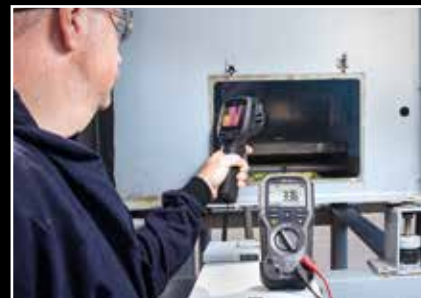
Utilice METERLiNK para incorporar lecturas eléctricas en las imágenes de la cámara de infrarrojos de FLIR.
