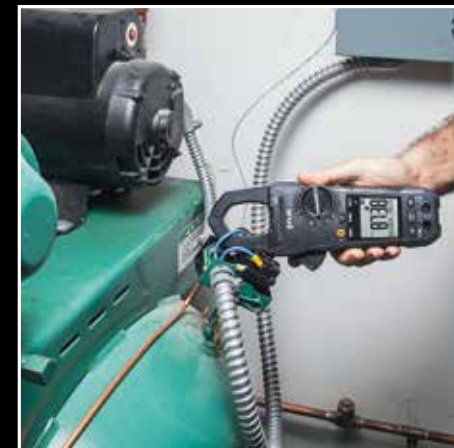
La corriente de inserción detecta subidas de corriente al arrancar.
