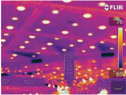
La función MSX nos permite ver mas detalles en la imagen térmica
