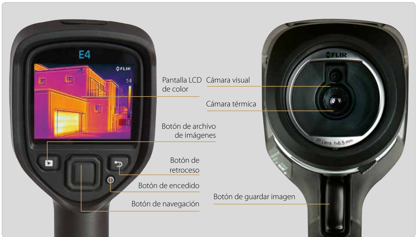
La función MSX nos permite ver mas detalles en la imagen térmica
